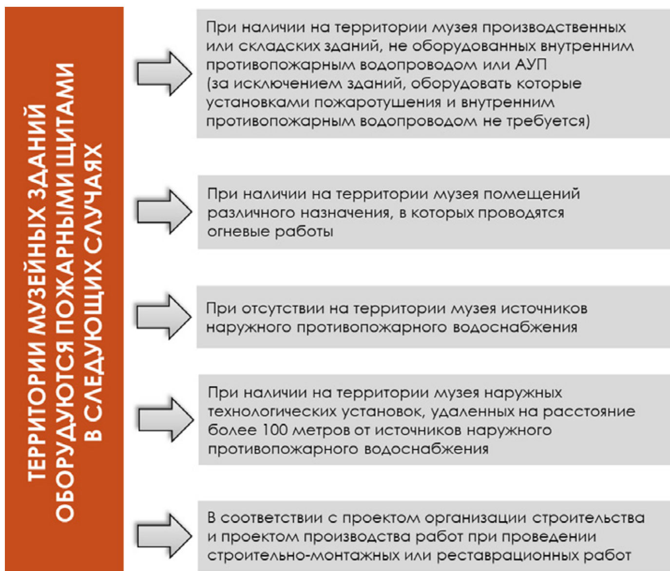
Рис. 8. Необходимость оборудования пожарными щитами территорий объектов.
