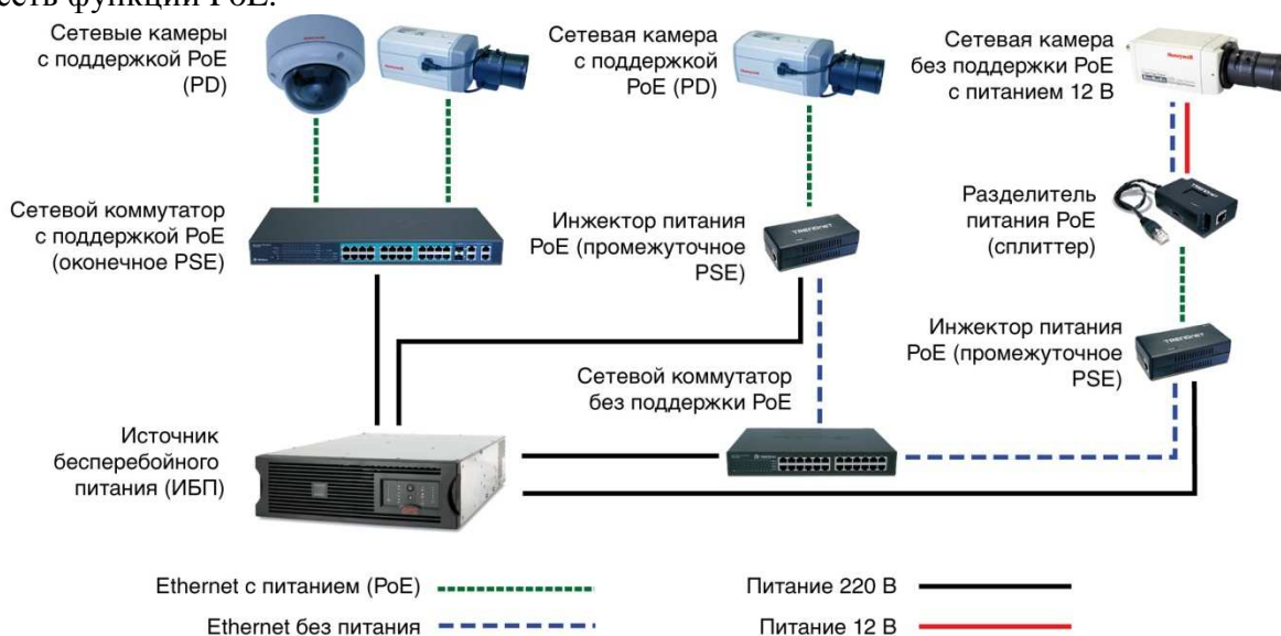
Рис. 7.2. Варианты использования технологии PoE.
