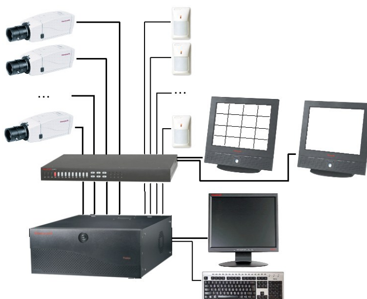
Рис. 5.4.11. ТВСН с дополнительным постом наблюдения
