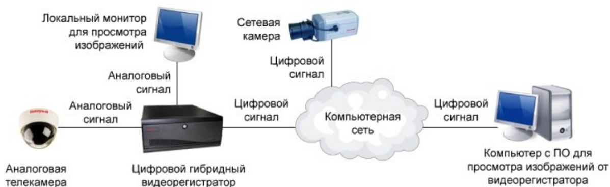
Рис.5.4.15. Сетевая система с гибридным видеорегастратором
