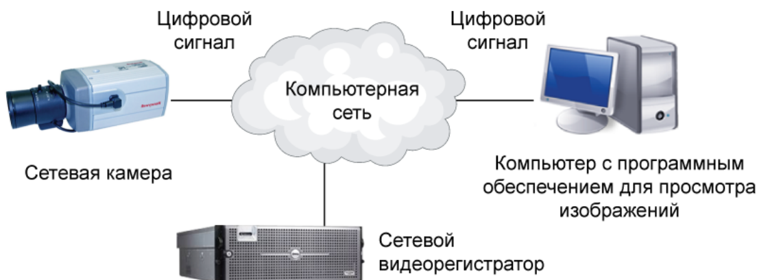
Рис. 5.4.18. Сетевая система с сетевым видеорегистратором
