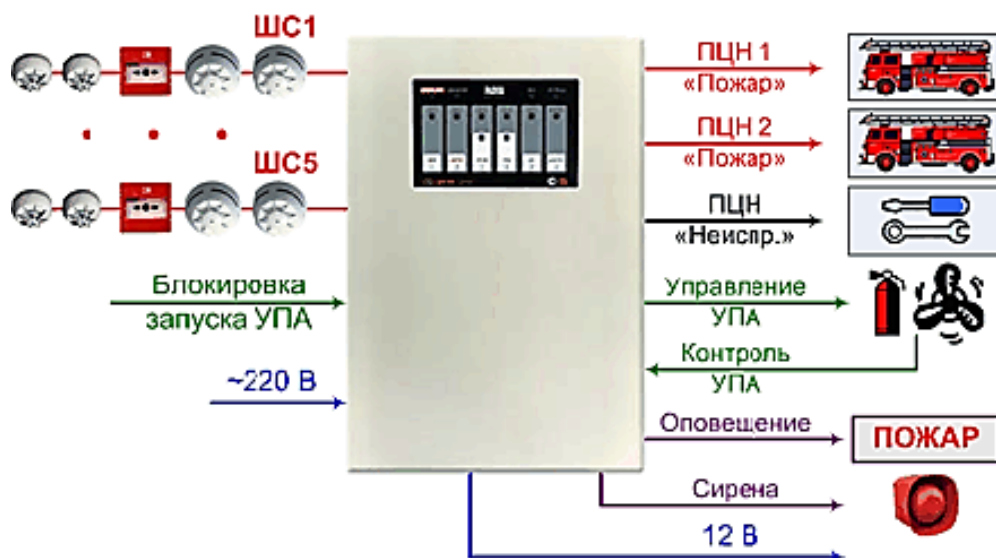
Рис. 5.2.1. Типовая структурная схема системы пожарной сигнализации.
