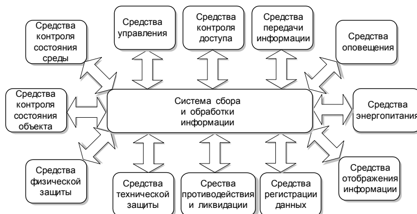
Рис. 5.1. Обобщенная структурная схема ТС СФЗ
