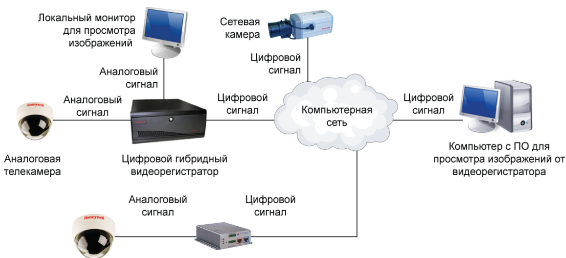
Рис. 5.4.16. Сетевая система с гибридным видеорегастратором и сервером.
