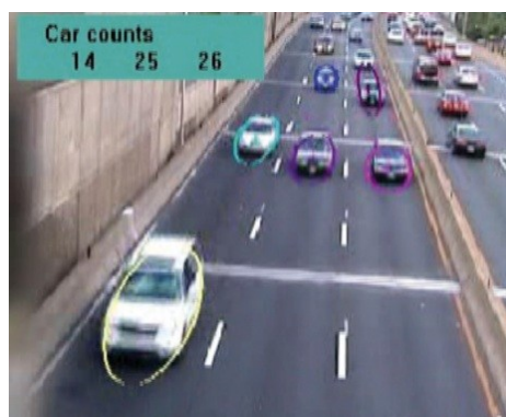
Рис. 5.4.60. Подсчет автомашин, движущихся по полосам
