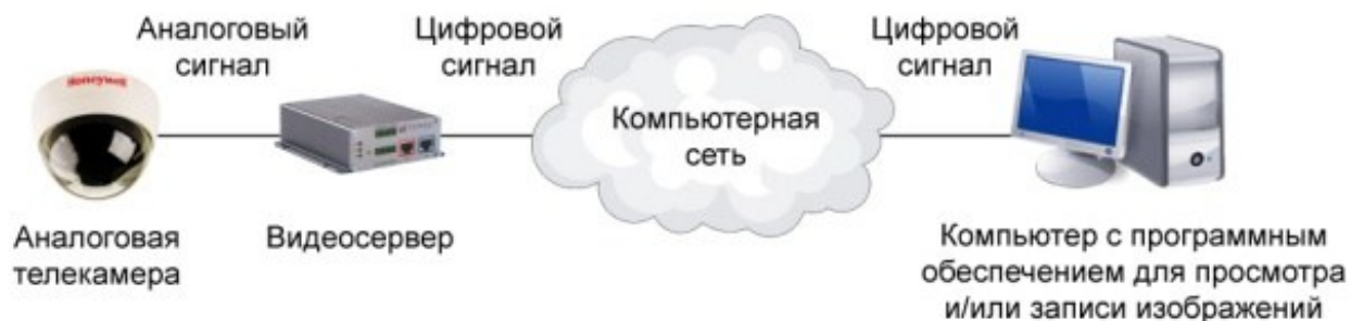
Рис. 5.4.14.. Сетевая комбинированная система с сетевым видеосервером
