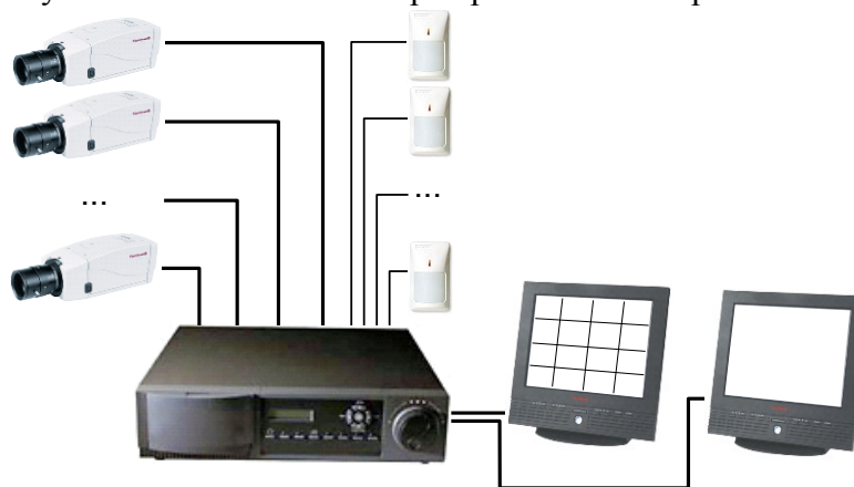
Рис. 5.4.10. ТВСН с цифровым многоканальным видеорегистратором
