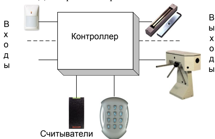
Рис. 5.3.9. Структура автономной СКУД
