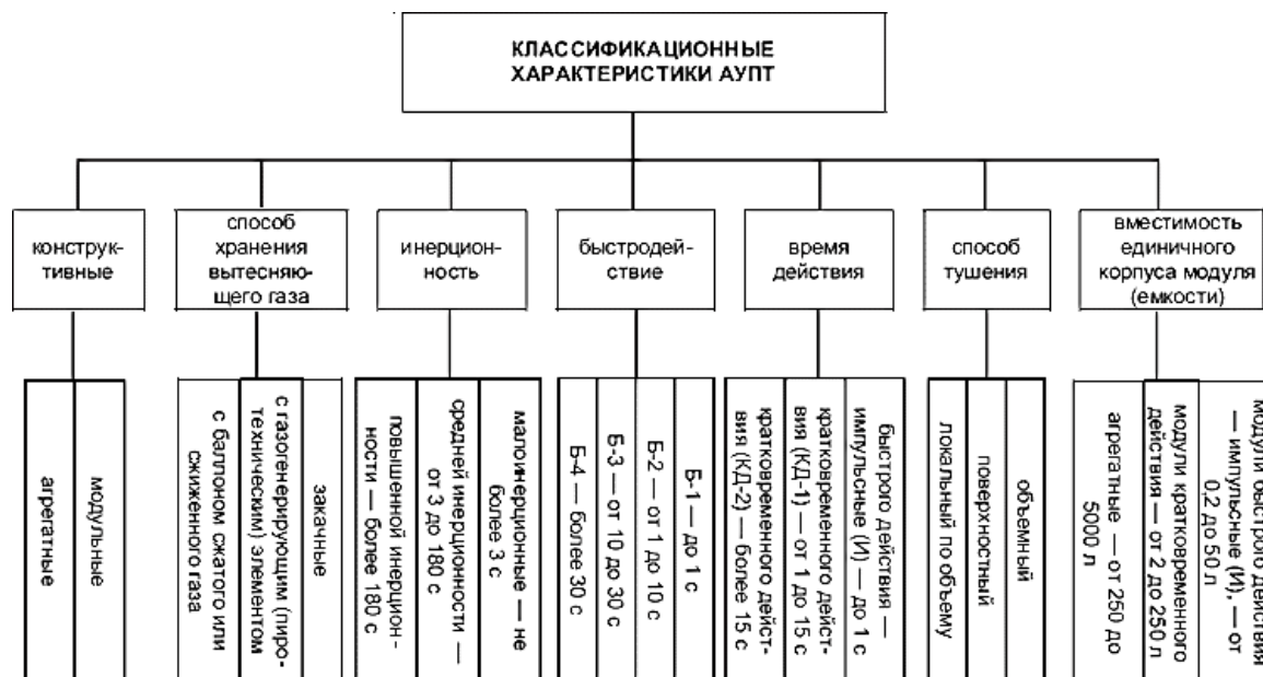
Рис. 5.2.6. Классификация газовых АУПТ
