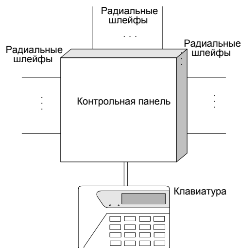
Рис. 5.1.2. ПКП на основе КП радиальной структуры
