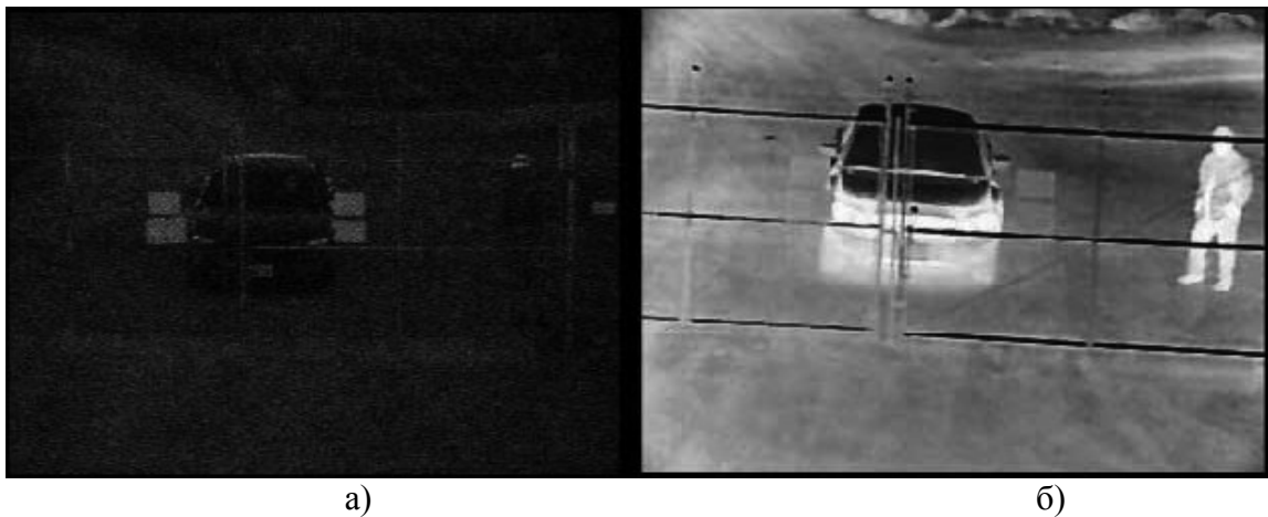
Рис. 5.4.54. Наблюдение с помощью ТВ-камеры (а) и тепловизора (б).
