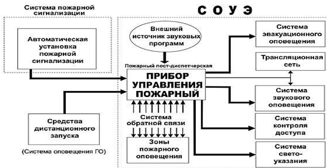
Рис. 5.10.1. Блок-схема единого комплекса на базе универсального прибора управления.
