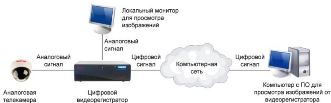
Рис. 5.4.13. Комбинированная сетевая система на базе гибридного видеорежистратора
