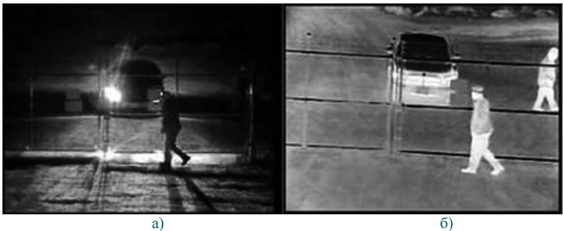
Рис. 5.4.55. Наблюдение с помощью ТВ-камеры (а) и тепловизора (б) при наличии встречной засветки.
