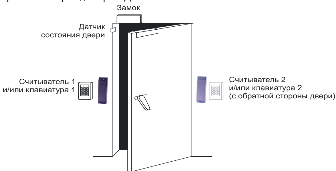
Рис. 5.3.4. Технические средства точки доступа с двухсторонним контролем
