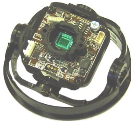
Рис. 5.4.29. Модули купольных телекамер
