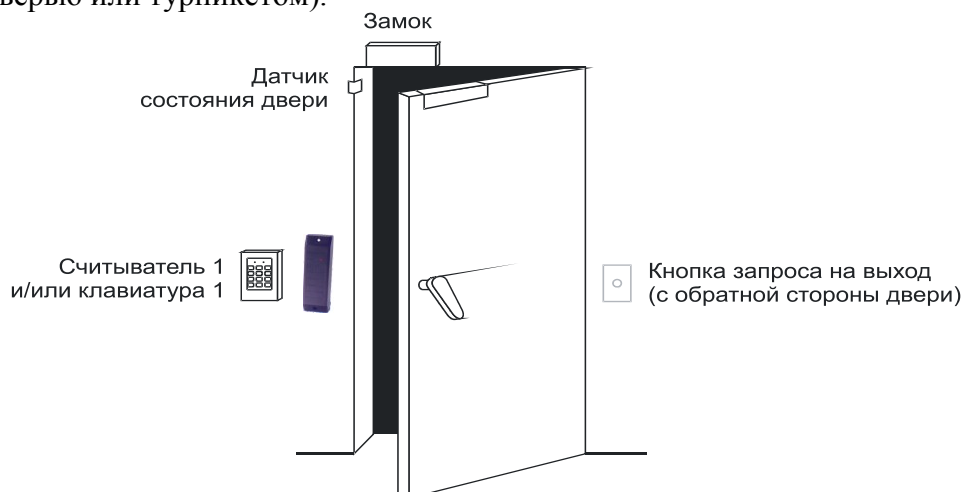
Рис. 5.3.3 Технические средства точки доступа с односторонним контролем
