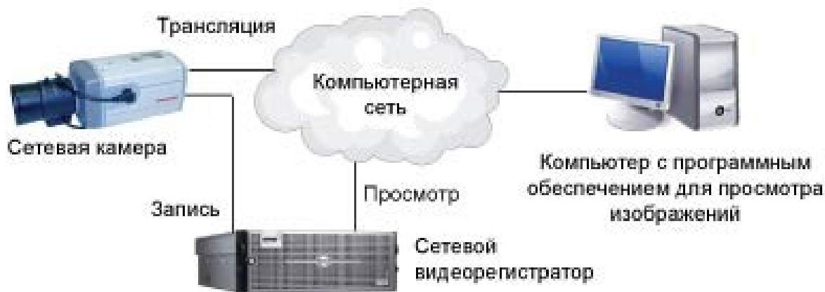
Рис. 5.4.19. Сетевая система с сетевым видеорегиистратором и отдельными каналами трансляции реального видео и видео для записи
