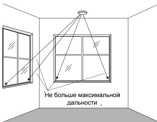
Рис. 5.1.13. Установка извещателя на потолке
