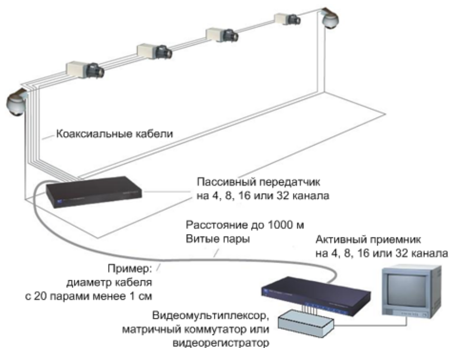
Рис. 5.4.21 Системы передачи аналогового видеоизображения с использованием витых пар
