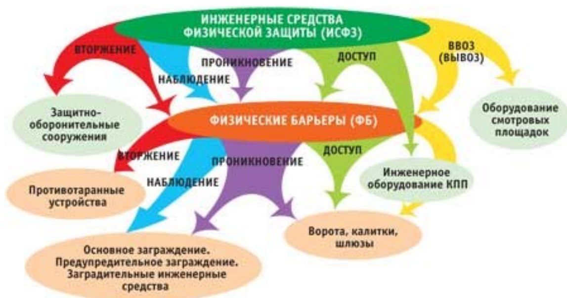
Рис. 5.5.1. Место физических барьеров в решении задач защиты системой инженерных средств физической защиты
