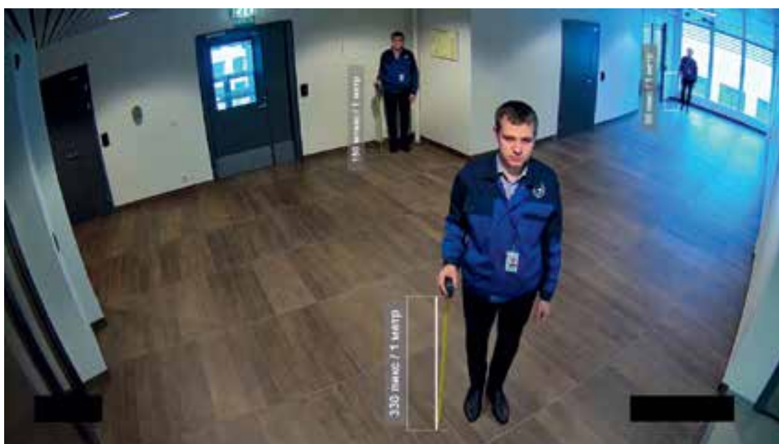
Рис. 6. Реальное изображение с видеокamеры с разрешением 1920x1080 с указанием плотности пикселей на 1 метр
