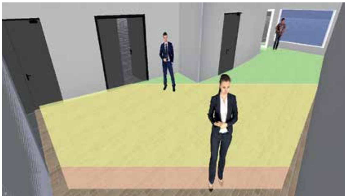
Рис. 5. Моделирование изображения с видеокamеры с цветовым обозначением зон: красный – идентификация, желтый – распознавание, зеленый – обнаружение
