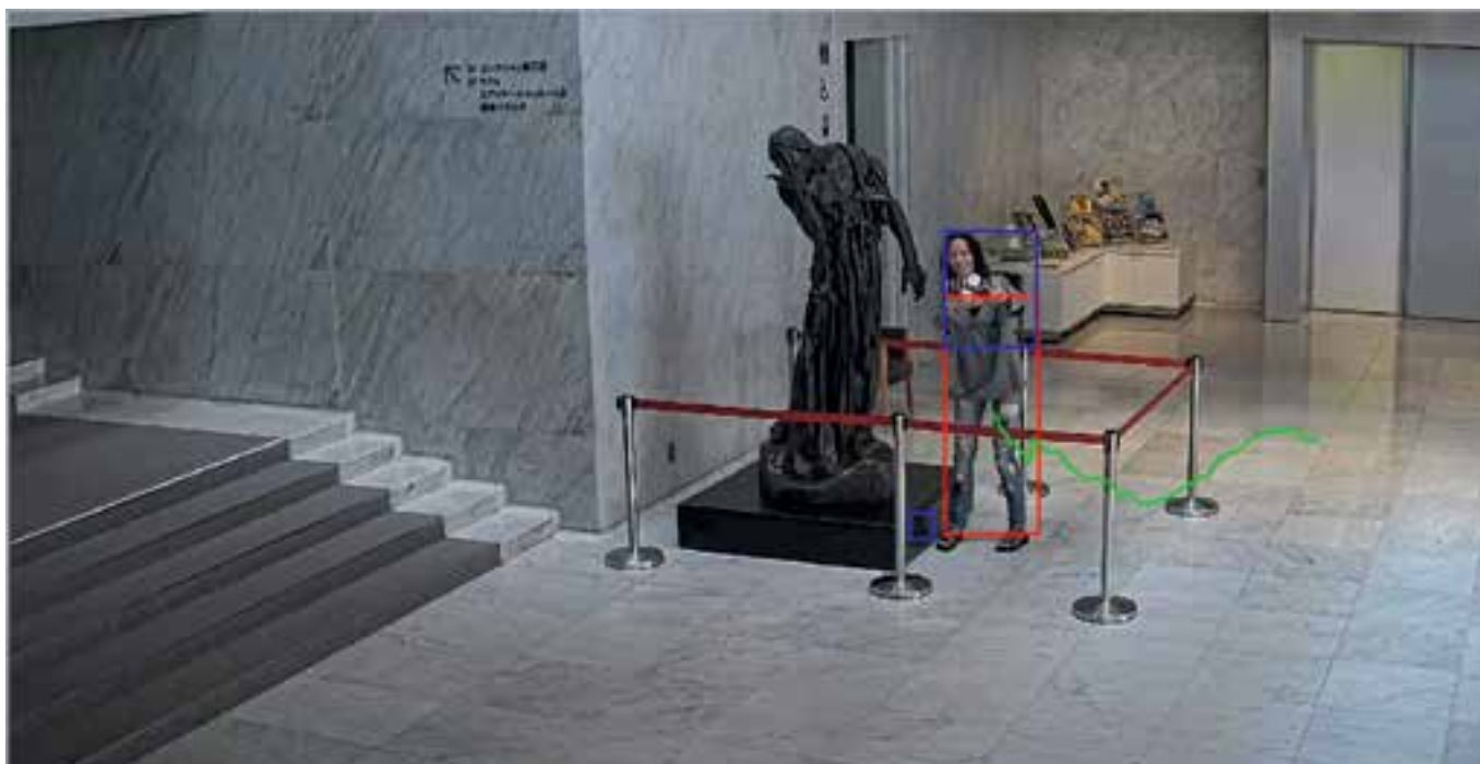
Рис. 31а. Виды видеоаналитики: вторжение в зону
