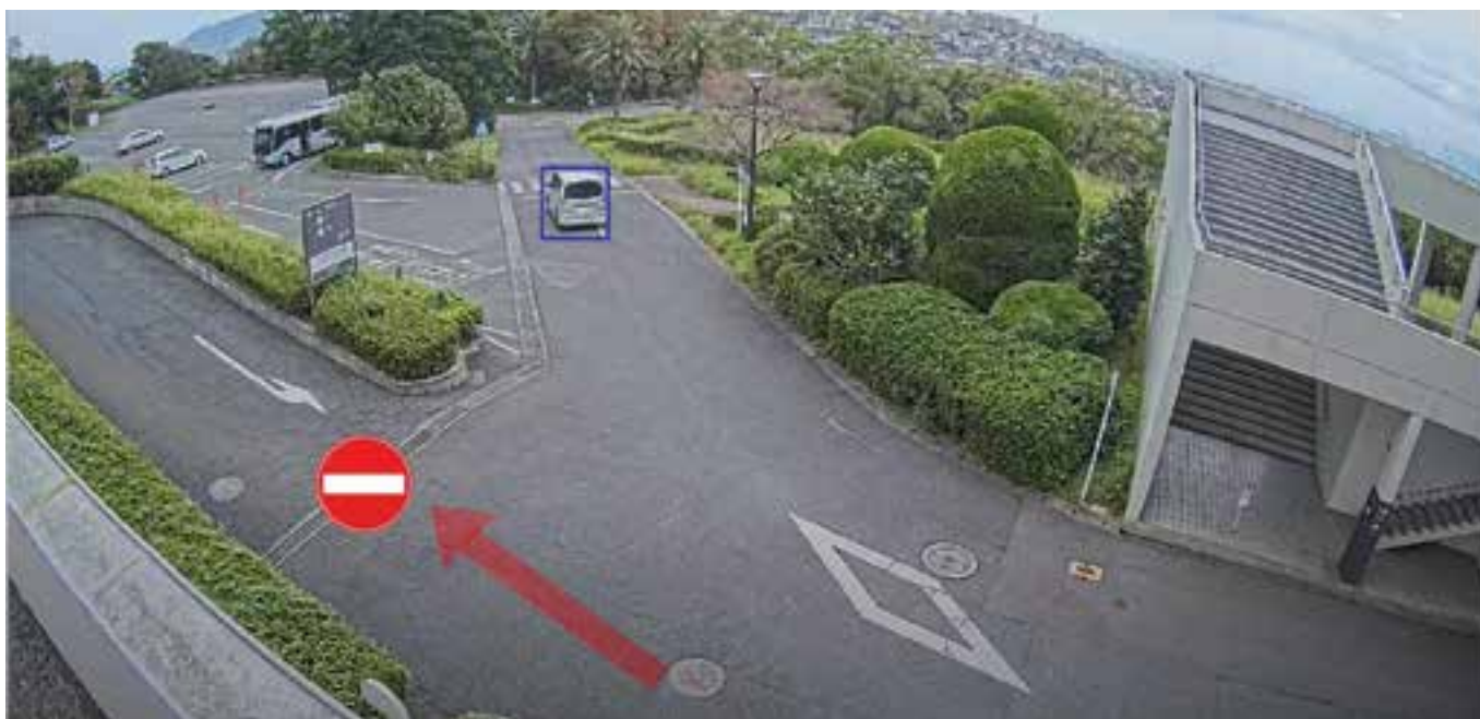
Рис. 31б. Виды видеоаналитики: неправильное направление
